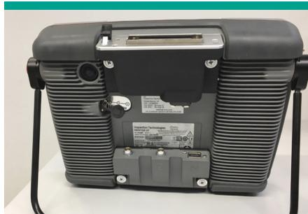
Mentor UT liefert einen integrierten Standardanschluss für Prüfköpfe. Wählen Sie aus den üblichen Tyco- oder Iplex-Anschlüssen.
