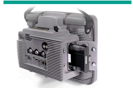
MUX mit erhöhter Kapazität von bis zu 32:128, erhältlich mit Tyco- oder Iplex-Anschluß.
