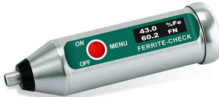
Das Ferritgehalts-Messgerät **List-Magnetik FERRITE-CHECK 110** ist ein kompaktes und handliches Gerät mit integrierter Sonde zur Messung des Ferritgehalts in austenitischen und Duplex-Stählen gemäß der Basler Norm DIN EN ISO 8249 nach dem magnetinduktiven Verfahren.
