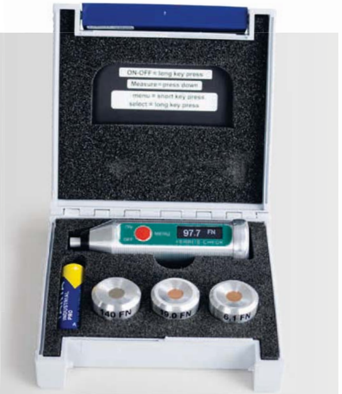
Kalibrieren des Ferritgehaltmessgerätes Das Ferritgehalts-Messgerät FERRITE-CHECK 140 wird mit 3 Kalibrierstandards geliefert, die nach dem NIST-Standard rückführbar kalibriert sind.
