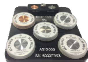
Leitfähigkeits-Testblöcke in Halterung.
