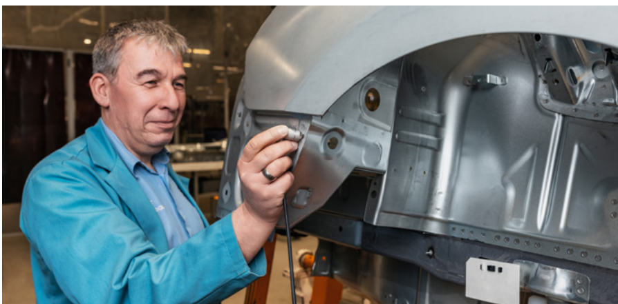
Krautkrämer SpotVision ist ein praktischer und leicht zu handhabender Prüfkopf
