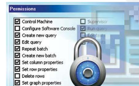
**Rückverfolgbarkeit und Datenintegrität** wird durch elektronische Signaturen sowie einen konfigurierbaren Baustein zur Regelung der Benutzerzugriffsrechte ermöglicht.
