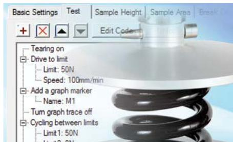
**Erweiterte mehrstufige Prüfungen** werden durch die vom Benutzer konfigurierbare Prüfung ermöglicht, wobei Sie mit Hilfe von einfachen integrierten Befehlen schnell erweiterte mehrstufige Prüfroutinen erstellen können.
